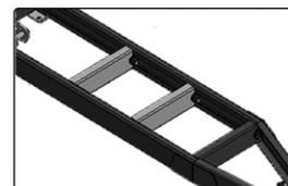
3 - ESTRUTURA CONSTRUÍDA POR VIGAS TUBULARES DE ALTA RESISTÊNCIA
