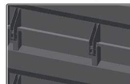
2 - SISTEMA DE MONTAGEM DAS TAMPAS LATERAIS, FRONTAIS E TRASEIRAS ATRAVÉS DE TRAVAS QUE PERMITEM O AJUSTE DE TAMANHO DE ACORDO COM A NECESSIDADE
