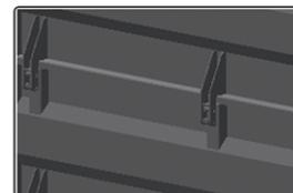
2 - SISTEMA DE MONTAGEM DAS TAMPAS LATERAIS, FRONTAIS E TRASEIRAS ATRAVÉS DE TRAVAS QUE PERMITEM O AJUSTE DE TAMANHO DE ACORDO COM A NECESSIDADE
